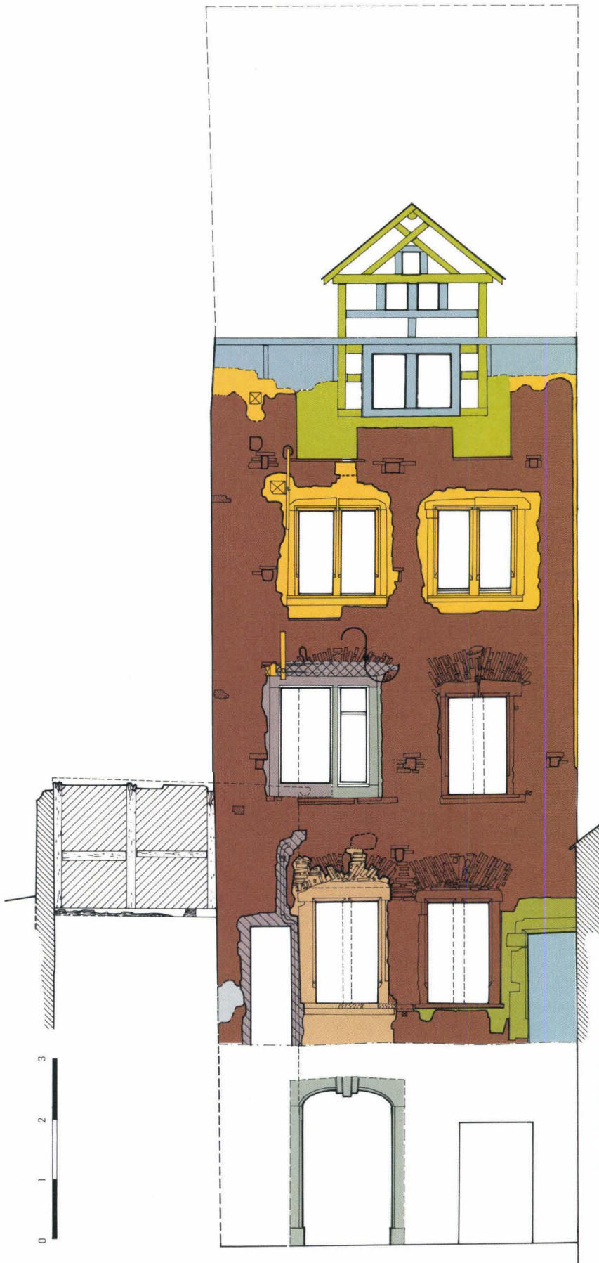
Abb. 29 Schneidergasse 28 / Pfeffergässlein 7 (D 2000/03). Ansicht der Hoffassade von Schneidergasse 28 mit Eintrag der Bauphasen. Das Erdgeschoss ist nicht untersucht.
