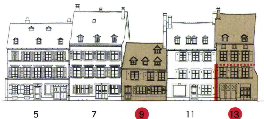
Abb. 5 Rebeggasse 13 (2005/23). Fassadenabwicklung nach Messbildern von 1997. Roter Balken: teiluntersuchte Brandmauer in Rebeggasse 13. Rot gestrichelt: die ungefähre Firsthöhe des ältesten fassbaren Vorgängerbaus. Sie betrug lediglich 6,5 m. Eine relativ geringe Gebäudehöhe ist noch bei Haus Nr. 9 erhalten. – Planbearbeitung: Stephan Tramèr.
