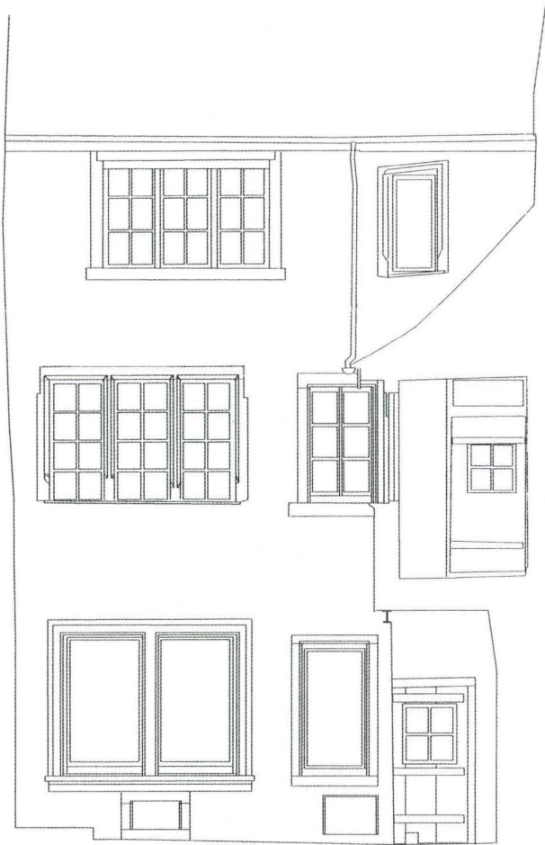
Abb. 23 Spalenvorstadt 25 (2004/248). Die Hoffassade vor dem Umbau 2005. Das Drillingsfenster im 1. Obergeschoss und das kleine, schiefgedrückte Fenster im 2. Obergeschoss sind weitgehend aus wiederverwendeten gotischen Werkstücken zusammengesetzt worden – vermutlich um 1630. Aus dieser Zeit könnten das Drillingsfenster im 2. Obergeschoss und das schmale Fenster im 1. Obergeschoss sein, ebenso die Kellerlichter. Die Fenster im Erdgeschoss sind stilistisch dem 19. Jahrhundert zuzuweisen. – Die beiden Türblätter, jedenfalls das Blatt der Tür auf die Laube im 1. Obergeschoss, stammen aus dem 17. Jahrhundert. Im 19. Jahrhundert wurden sie mit Fenstern ergänzt. – Plan: Erik Schmidt. Überarbeitung: Matthias Merki.
