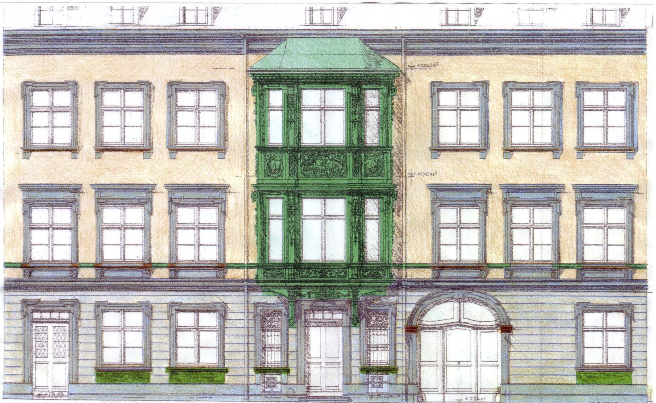
Abb. 5 St. Alban-Vorstadt 17 – Zum Geist (2003/252). Strassenfassade. Braun: Reste der Barockfassade (s. Abb. 3). Blaugrau: Architekturteile von Christoph Riggenbach, um 1850. Blaugrün: Erker, Einbau 1903 durch La Roche Stähelin & Cie. Grün: Spätere Auswechslungen. – Plangrundlage: Technischer Arbeitsdienst. Überarbeitung: Matthias Merki.
