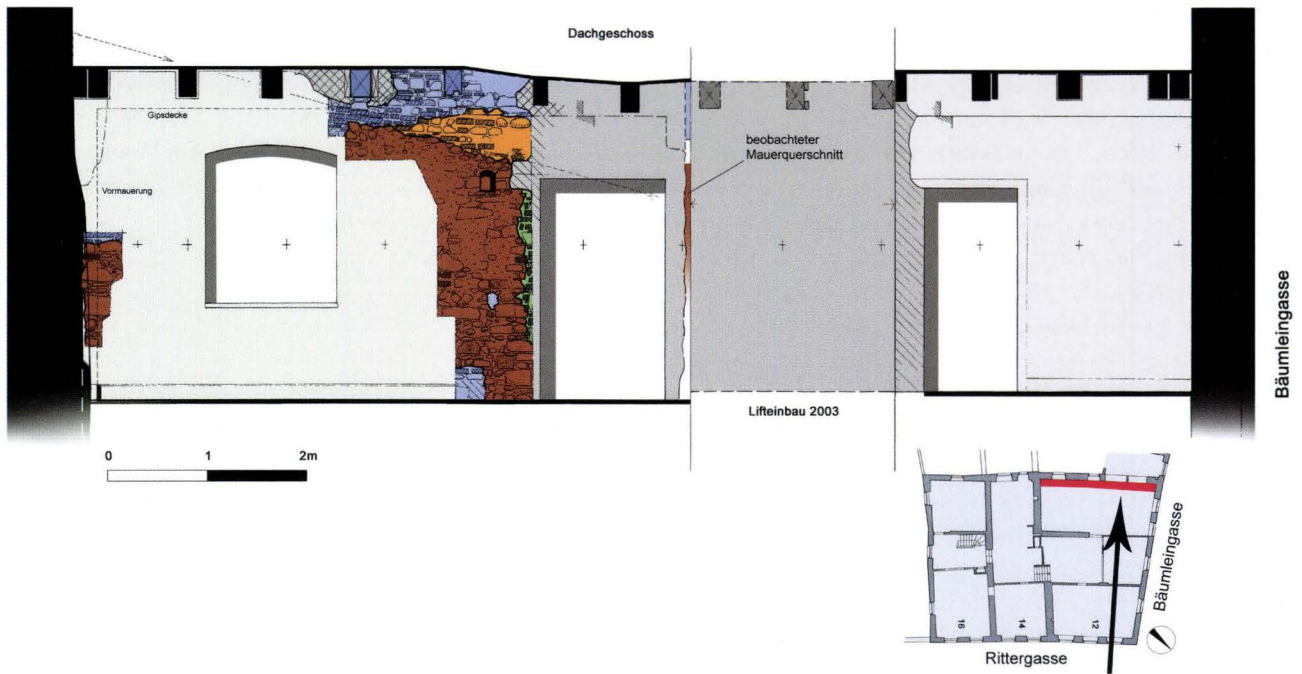
Abb. 14 Rittergasse 12 (2003/27). Ansicht der Innenseite (rot markiert) der Hoffassade des «Eptingerhofs» im 2. OG. Eine älteste Mauerpartie steckt im südlichen Abschnitt (braun). Die mittelalterliche Mauer enthält viel Bruchsteine und wenig Backsteine und ist mit grobkiebigem Mörtel vermauert. Die Mauerkrone endete mit einer im Winkel von 17 Grad Richtung Kernbau (links) ansteigenden Dachlinie (gestrichelt ergänzt). Knapp darunter ein originales, später zugemauertes Balkenloch (wohl von einer Dachpfette). Im unteren Teil konnte ganz links der Anstoss der Mauer an die Kernbaumauer des Hauses «Zum Gemar» festgestellt werden. Von Form und Charakter her gehört die Mauer eindeutig in die Gruppe der mittelalterlichen Steinbauten. – Aufnahme und Bearbeitung: Stephan Tramèr.
