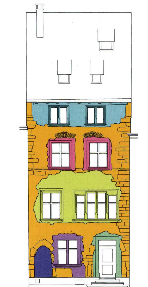
Abb. 6 Die mit 8 m Breite und mit 2 ungleich grossen Toren sehr vergleichbare Strassenfassade der Augustinergasse 17 war im Zuge einer Neubebauung nach dem Erdbeben um 1363 entstanden. Die Eckquader des Fassadenmauerwerks binden rechts eine breite Rundbogenöffnung als Durchfahrt ein. Am linken Rand sitzt der Hauseingang. Im 2. OG verläuft ein durchgehendes Gurtgesims, auf dem die Fenster aufsitzen. Darüber lag das Dach zwischen Stufengiebeln. – Bauaufnahme und Bearbeitung: Basler Denkmalpflege.
