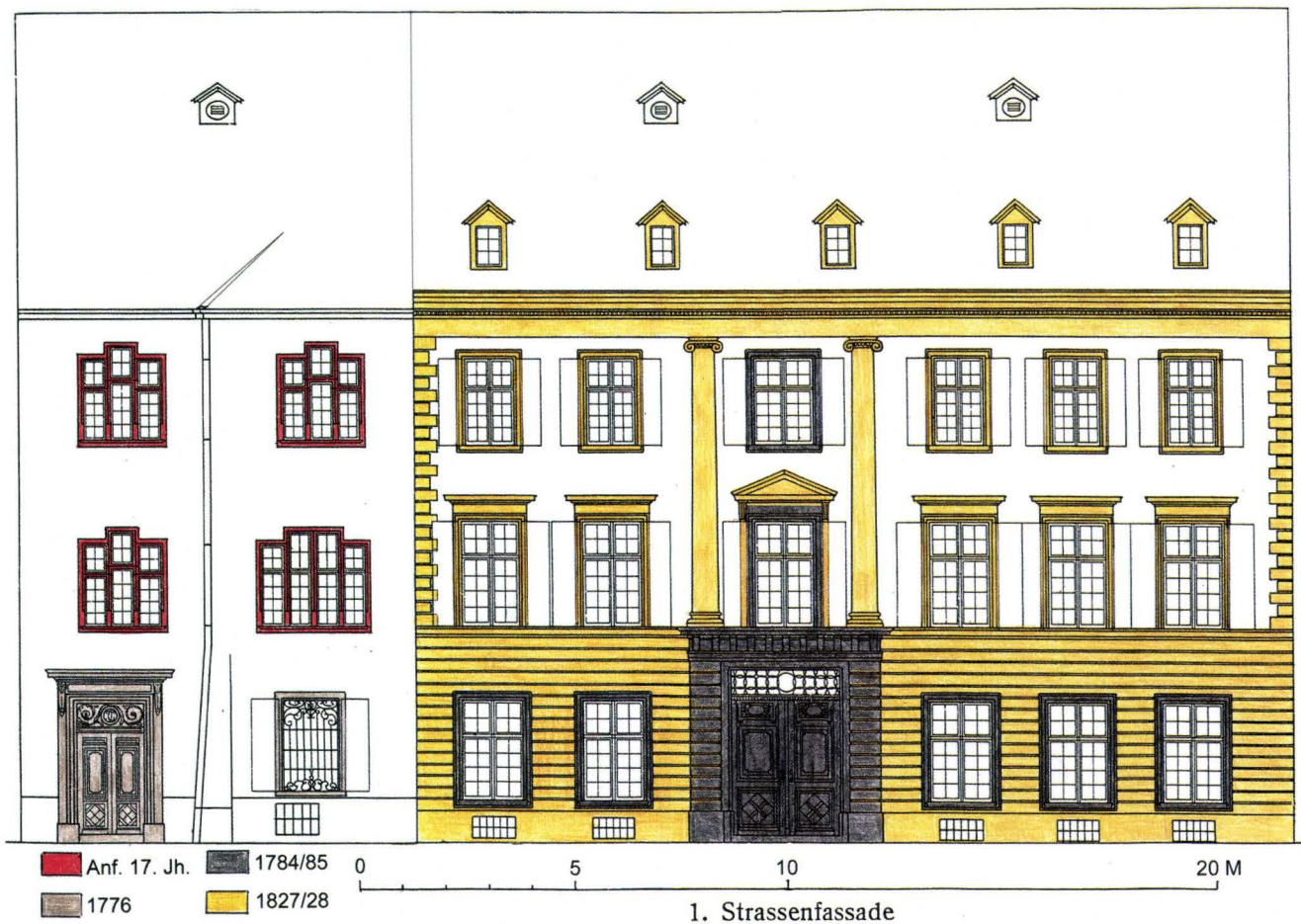
Abb. 14 St. Johanns-Vorstadt 15/17, Sant Christoffel / Erlacherhof (2003/280). Strassenfassaden. Die Einfärbungen zeigen die unterschiedlichen Zeitstellungen der Architekturelemente. Rot: Anfang 17. Jahrhundert, hellgrau: 1776, dunkelgrau: 1784/85, gelb: um 1827. – Zeichnung aus: Das Bürgerhaus in der Schweiz , XXIII. Band, Kanton Basel-Stadt (III. Teil) und Basel-Land, Zürich und Leipzig 1931. Überarbeitung: Matthias Merki.
