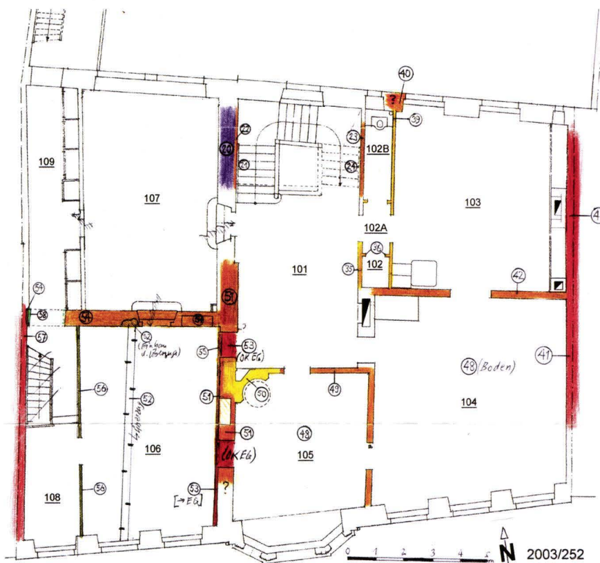
Abb. 9 St. Alban-Vorstadt 17 – Zum Geist (2003/252). Erstes Obergeschoss. Im linken Hausbereich die massive, von der ehemaligen Brandwand Richtung Westen abgehende Mauer, die vermuten lässt, dass die westlichste der ursprünglich vier Parzellen die ganze Breite zwischen der heutigen Westbrandmauer und der ehemaligen Brandwand belegte. Die ockerfarbigen Fachwerkwände sind wie die Treppe von 1719. Die Nische (gelb) des Zylinderofens, der von der Halle aus beheizt wurde, stammt aus dem 19. Jahrhundert. – Plan: Technischer Arbeitsdienst. Ergänzungen: Matthias Merki.
